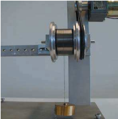
旋转轴表面进给测量设备“螺纹法”
